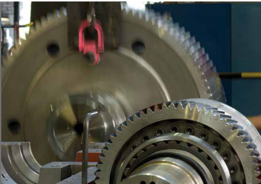
Schiffsgetriebe vor der Applizierung für den Prototypentest
