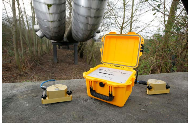
SUMMIT M Hydra Seismograph mit Sensoren
