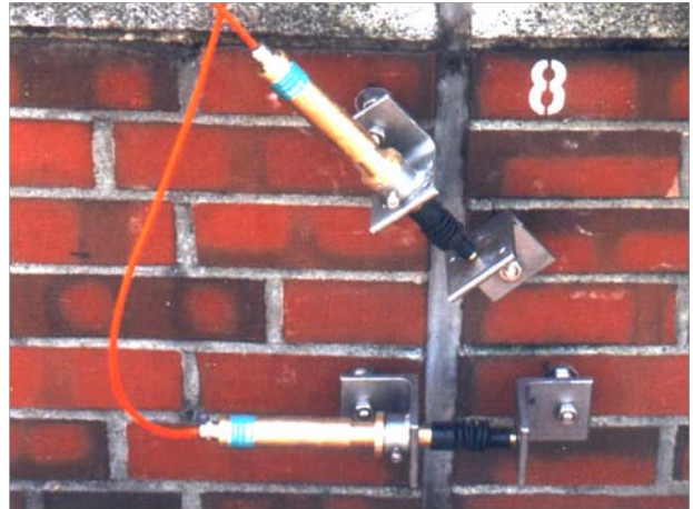
Fugenüberwachung mit Fissurometern an einer Kaimauer
