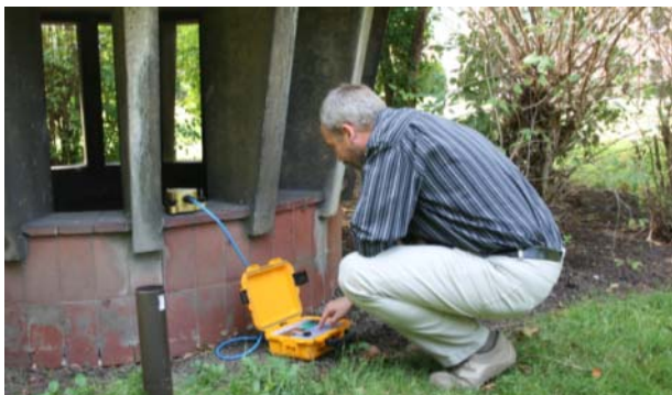
Erschütterungsmessung an einem Luftschaft
