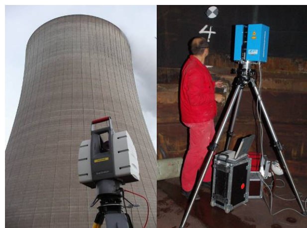
Laserscanner im Messeinsatz
