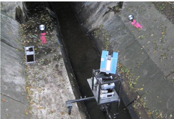
Laserscanner im Messeinsatz (Ahbachkanal, Bochum)
