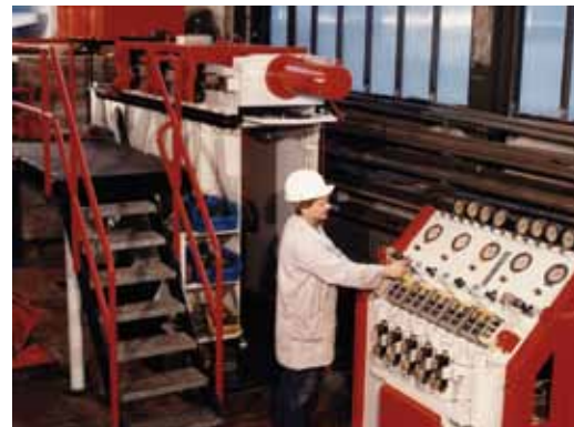
Banco de pruebas de cizallamiento para pernos de anclaje montados
