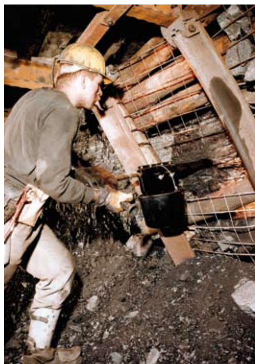
Разведочное бурение – определение опасности горных ударов
