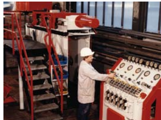
Scherprüfstand für eingebaute Gebirgsanker
